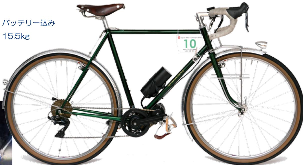
前照灯は試作のLED砲弾型ライト。後ろはリフレクターを改造し、内部にLEDを仕込んである。前後のライトはハブダイナモから給電される。
