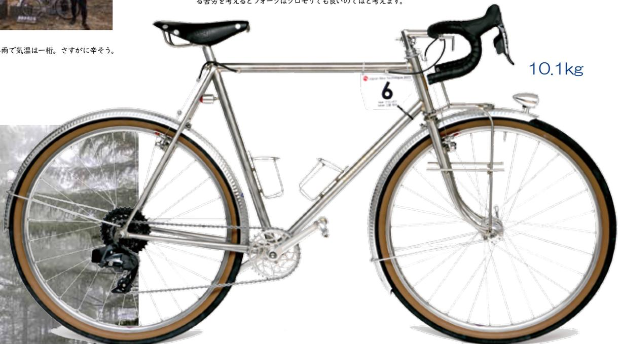
タイヤはグランボア 650 × 42B エートルをベースにした試作タイヤ。チューブはラテックスチューブの PLUME。エートルのような太くて軽いタイヤとラテックスチューブの組み合わせは乗り心地が良くスムーズで速い。この試作タイヤは 2023 年春の製品化が決定しました！
