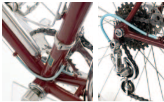
ワイヤー類はすべてフレームに直付けしたワイヤーリードで外だしてアッセンブル。
