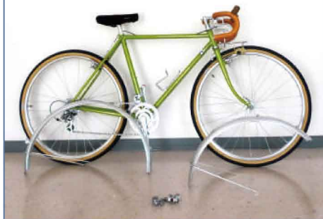
アーチワイヤーを外す。 レバーのブレーキワイヤーを抜く。 (抜く必要のないものもあります。)
