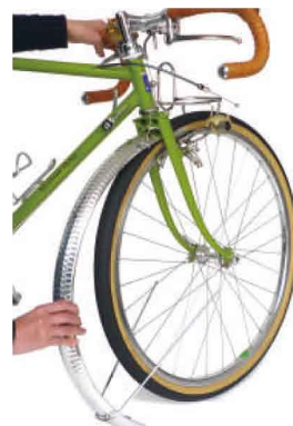
計4カ所の固定を緩め、後ろに引く。
