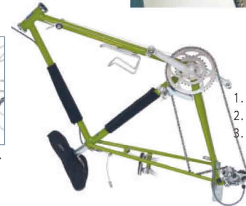
クイックリリースを開く。 ディレーラーを後ろに下げ、後輪を外す。
