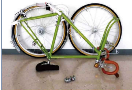
クイックレバーを開いて、ディレーラーを後ろに下げ、前輪を外す。 ディレーラーを後ろに下げ、後輪を外す。
