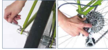
クイックリリースを開く。 ディレーラーを後ろに下げ、後輪を外す。
