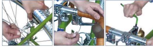
アーチワイヤーを外し、ブレーキワイヤーを抜く。 ステムを緩めて、ハンドルと一緒に抜く。
