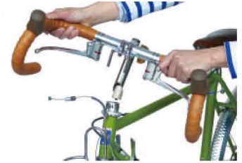
アーチワイヤーを外し、ブレーキワイヤーを抜く。 ステムを緩めて、ハンドルと一緒に抜く。
