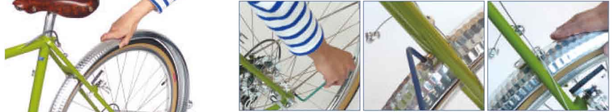
左右のステー 上ブリッジ部 ER ボルト 3ヶ所緩めたら、軽く上から押さえる。
