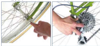
クイックレバーを開いて、ディレーラーを後ろに下げ、前輪を外す。 ディレーラーを後ろに下げ、後輪を外す。
