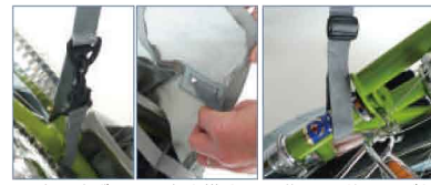
肩紐はまずはBBに紐を掛け、最後にヘッドチューブと袋の穴に紐先を通す。 結ぶ。
