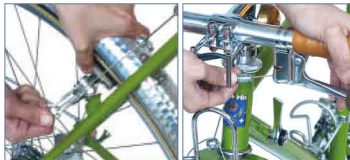
アーチワイヤーを外す。 レバーのブレーキワイヤーを抜く。 (抜く必要のないものもあります。)
